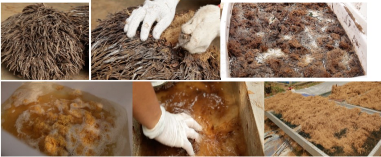
Gambar 1 Ekstraksi serat TKKS dengan output serat panjang dan pendek
